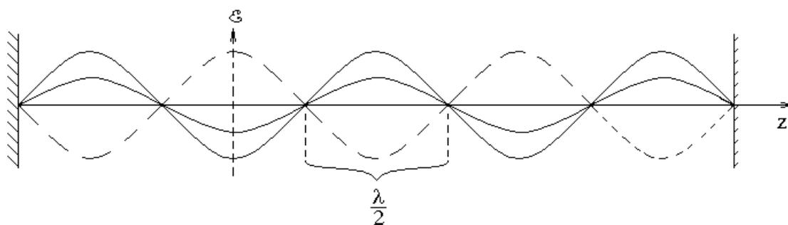
В резонаторе работающего лазера присутствует стоячая волна. На зеркалах лазера находятся узлы стоячей волны. Следовательно, на длине резонатора  $L$  укладывается целое число полуволен  $L = m \frac{\lambda}{2}$ , где  $m = 1, 2, 3, \dots$  — целое число. Лазер может излучать только такой свет, длина волны  $\lambda$  которого удовлетворяет равенству  $L = m \frac{\lambda}{2}$ .
