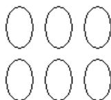
Так если форма лазерного пятна представляет собой две строки по три светлых пятна, то индексы соответствующей поперечной моды 2,1 — две темные полосы при перемещении по  $x$  координате и одна темная полоса при перемещении по  $y$  координате.
