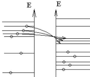
Металлы при этом заряжаются: один — положительно, другой — отрицательно. Между ними возникает напряжение — контактная разность потенциалов.
