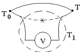
Один спай термопары будем поддерживать при опорной температуре  $T_0$ , например при температуре смеси воды со льдом — ноль градусов Цельсия. Другой спай термопары поместим в точку измерения температуры  $T$ . Все остальные возможные контакты металлов в цепи вольтметра будем поддерживать при одинаковой температуре  $T_1$ . Значение температуры  $T_1$  не существенно.
