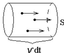
$$I = \frac{dQ}{dt} = \frac{q \cdot dN}{dt} = \frac{q \cdot n \cdot dV_0}{dt}, \text{ здесь } n \text{ — концентрация зарядов, } q \text{ —}$$
