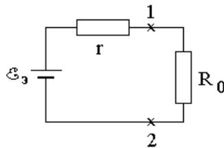
Две схемы эквивалентны в том смысле, что для каждой величины сопротивления  $R_0$  обе схемы создают в этом резисторе одинаковый ток.
