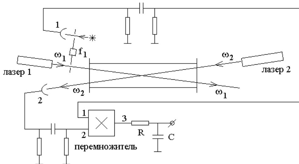
Синхронное детектирование сигнала происходит на аналоговом перемножителе сигналов. Перемножитель — это микросхема с двумя входами и одним выходом, не считая выводов питания и коррекции.
