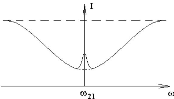
Здесь  $\omega_{21}$  — центр линии поглощения среды. Зависимость мощности света на приемнике от частоты лазера имеет широкий провал доплеровской линии поглощения, в центре которого находится узкий пик просветления среды. Пик просветления — это и есть резонанс насыщения поглощения.
