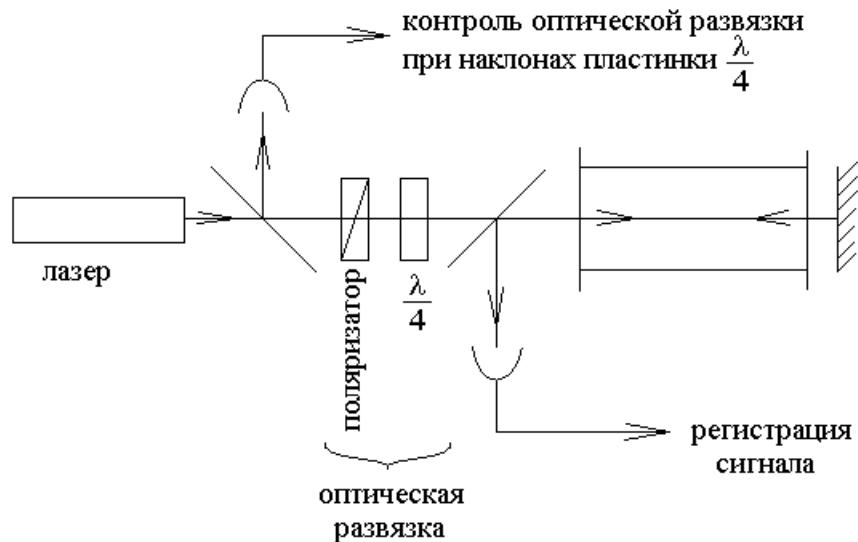
Второй вариант оптической схемы имеет два приемника лазерного излучения. Сигнал насыщения поглощения регистрируется в излучении, падающем на нижний приемник. Верхний приемник служит для контроля качества оптической развязки.
