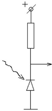
Напряжение на выходе схемы линейно минусует с ростом интенсивности света.
