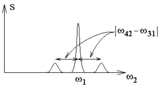
Если регистрировать сигнал  $S$ , как функцию модуля разности частот лазеров, то экспериментальная кривая будет иметь следующий вид:
