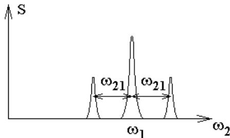
Если измеряется зависимость сигнала синхронного детектирования  $S$  от частоты биений двух лазеров  $\Delta\omega$ , то экспериментальный сигнал примет следующий вид:
