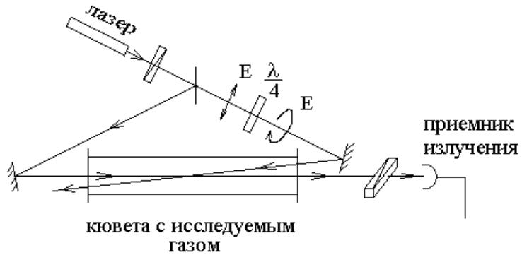
Свет лазера проходит через поляризатор. Линейно поляризованный свет отражается от полупрозрачной пластиинки и от зеркала и проходит кювету с исследуемым газом слева направо. Встречная световая волна, распространяющаяся справа налево, имеет круговую поляризацию, которая получается из линейной поляризации с помощью фазовой пластиинки  $\frac{\lambda}{4}$ .
