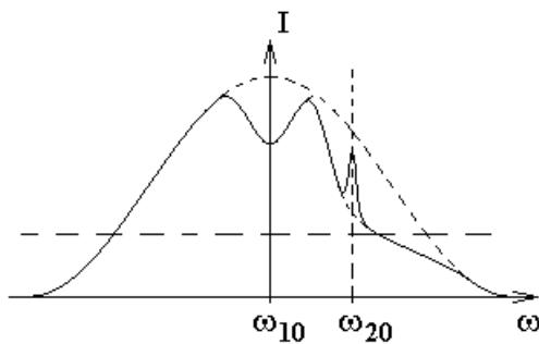
Здесь широкий выпуклый контур с центром на частоте  $\omega_{10}$  — это контур линии усиления среды уширенный эффектом Доплера. В центре контура линии усиления на рисунке изображен провал Лэмба.
