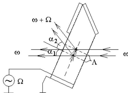
Пусть световая волна с частотой  $\omega$  падает на акустооптический модулятор справа налево. Плоскости с большим и меньшим показателем преломления вещества представляют собой фазовую дифракционную решетку
