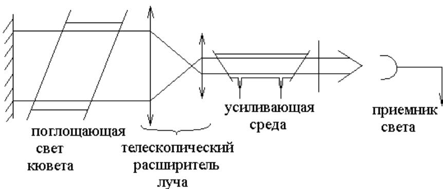
Расширение пучка лучей в резонаторе лазера уменьшает интенсивность света и уменьшает уширение резонанса насыщения поглощения.
