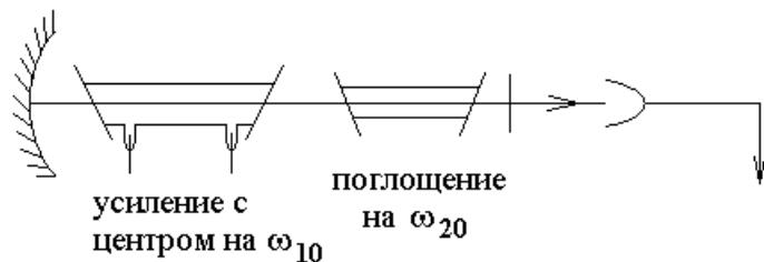
В резонаторе лазера есть две встречные волны, которые просветляют кювету друг для друга.
