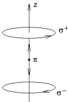
Вращение диполя, которое образует правый винт с направлением оси квантования, излучает так называемую  $\sigma^+$  компоненту света. Вращение диполя, которое образует левый винт с осью квантования, излучает  $\sigma^-$  компоненту света. Первоначально  $\sigma^+$  и  $\sigma^-$  компоненты определялись наоборот. На рисунке для наглядности вращения смешены по оси  $z$  вверх и вниз.
