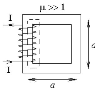
Рассмотрим циркуляцию поля  $\vec{H}$  по новому пунктирному контуру. Казалось бы, магнитное поле в основном сосредоточено в сердечнике, поэтому вкладом в циркуляцию снаружи сердечника можно пренебречь. Тогда
