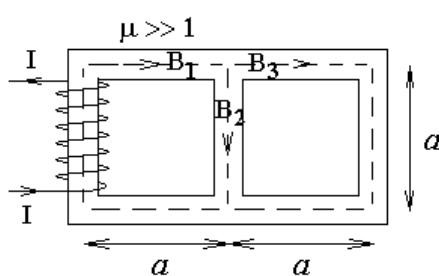
Выберем в качестве контуров для составления уравнений два элементарных квадратных пунктирных контура. Выберем положительное направление обхода каждого контура, например по часовой стрелке.
