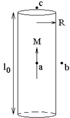
Здесь точка  $a$  находится в центре цилиндра, точка  $b$  — у боковой поверхности цилиндра в середине его высоты, точка  $c$  — непосредственно над серединой торца цилиндра.
