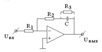
Подъем начинается с частоты  $\omega = \frac{1}{R_2C}$  и происходит на более низких частотах. Параллельно конденсатору можно подсоединить большое сопротивление  $R_3$  для прекращения подъема на очень низких частотах  $\omega = \frac{1}{R_3C}$ .
