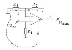
В качестве примера рассмотрим усилитель напряжения на операционном усилителе. Входной сигнал подадим на плюс вход ОУ. Минус вход через сопротивление  $R_1$  соединим с общим проводом схемы. Выход ОУ через сопротивление  $R_2$  соединим с минус входом.
