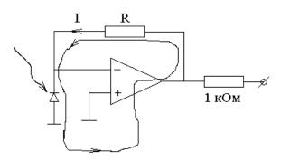
Под действием света в фотодиоде возникает фототок пропорциональный мощности света. Этот ток не может протекать через "-" вход операционного усилителя. Следовательно, весь фототок протекает через резистор обратной связи сопротивлением R. Типовое значение сопротивления R=1MOM.
