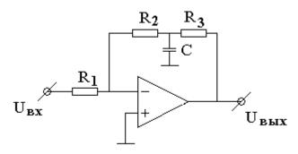
Пусть  $R_2\gg R_3$ , тогда подъем начинается с частоты  $\omega=\frac{1}{R_3C}$ . Последовательно с конденсатором можно поставить малое сопротивление  $R_4$  для прекращения подъема на более высоких частотах  $\omega=\frac{1}{R_4C}$ .
