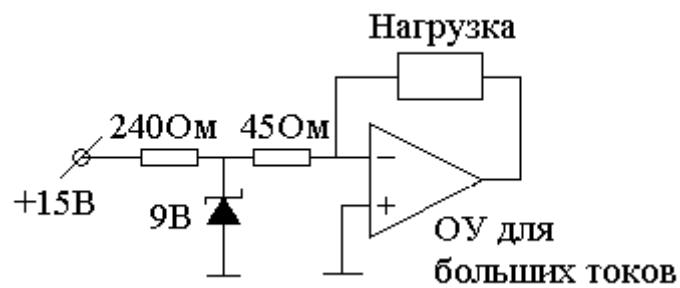
Выходной каскад на ОУ со стократным усилением для звуковых частот:
