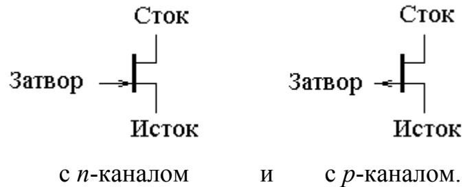
с *n*-каналом и с *p*-каналом.
