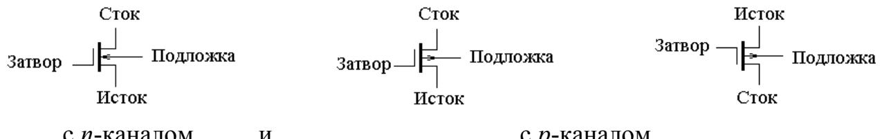
с *n*-каналом и с *p*-каналом.
