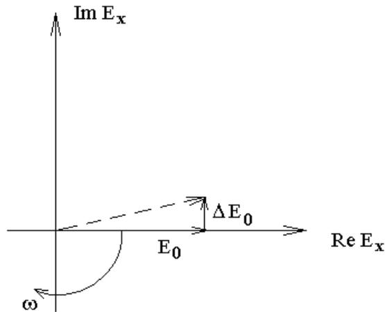
Здесь  $\vec{E}_0$  — комплексная амплитуда падающей световой волны,  $\Delta\vec{E}_0$  — амплитуда излучения слоя диполей. Пунктирный вектор — это комплексная амплитуда света после прохождения тонкого слоя среды. Комплексная амплитуда повернулась против вращения во времени комплексной напряженности светового поля. Это означает отставание по фазе световой волны после прохождения тонкого слоя среды от световой волны, которая распространялась бы в вакууме.
