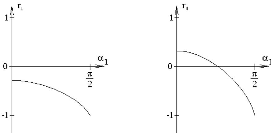
Из рисунка можно сделать вывод, что при отражении света от оптически более плотной среды векторы  $\vec{E}$  отраженной и падающей волн направлены навстречу друг другу или почти навстречу при любом угле падения и любой поляризации света. Для поляризации перпендикулярной плоскости падения
