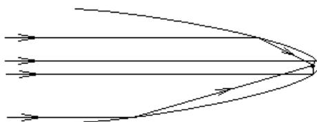
В фокусе зеркала можно поставить приемник излучения. Свет от удаленного источника будет собираться на приемнике в том случае, если направить ось параболического зеркала на источник излучения. Поэтому такое параболическое зеркало и приемник в его фокусе можно рассматривать, как телескоп.
