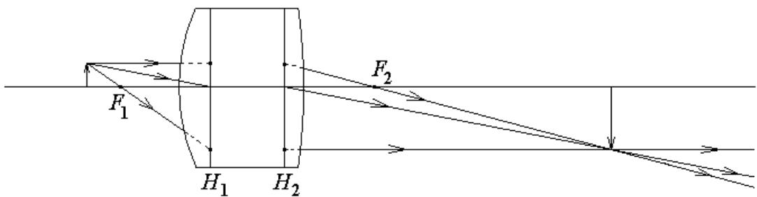
На рисунке приведен пример построения изображения предмета оптической системой с заданными главными плоскостями  $H_1$  и  $H_2$ , и заданными положениями фокусов  $F_1$  и  $F_2$ . Для построения изображения достаточно рассмотреть любые два луча из трех приведенных на рисунке.
