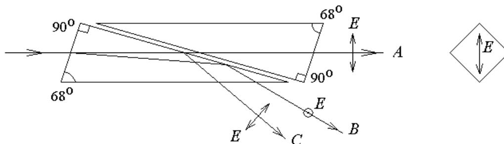
Луч  $B$ , поляризованный перпендикулярно плоскости рисунка, испытывает полное внутреннее отражение, поэтому в прошедшем горизонтально луче  $A$  нет поляризации перпендикулярной плоскости рисунка. Прошедший луч  $A$  полностью поляризован. Так из неполяризованного света на входе призмы Николя на ее выходе получается линейно поляризованный свет.
