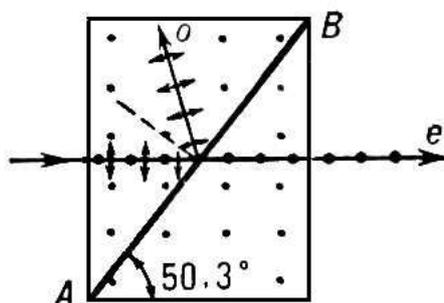
Угол  $50.3^{\circ}$  треугольной кристаллической призмы рассчитан таким образом, что полное внутреннее отражение для одной из двух линейных поляризаций света происходит при нормальном падении света на одну из граней призмы Глана-Тейлора.
