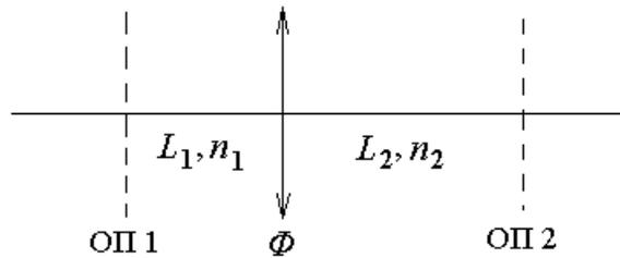
Здесь  $\Phi$  — оптическая сила линзы,  $n_1, n_2$  — показатели преломления сред с двух сторон линзы,  $L_1, L_2$  — расстояния от линзы до сопряженных опорных плоскостей.
