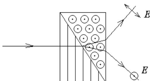
Одноосный кристалл разрезают, одну половину поворачивают на  $90^{\circ}$  и две половины склеивают так, чтобы ось кристалла в двух половинах образца была направлена взаимно ортогонально. На рисунке это вертикальное направление для левой части кристалла и направление перпендикулярное плоскости рисунка для правой части кристалла.
