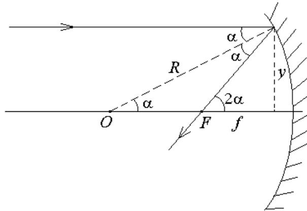
На рисунке обозначены буквой  $\alpha$  три одинаковых угла, которые примыкают к отрезку, обозначенному на рисунке буквой  $R$ . Этот отрезок — перпендикуляр к поверхности зеркала в точке касания зеркала лучом. Два верхних угла равны друг другу, как угол падения и угол отражения от зеркальной поверхности.
