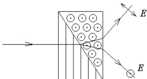
Одноосный кристалл разрезают, одну половину поворачивают на  $90^0$  и две половины склеивают так, чтобы ось кристалла в двух половинах образца была направлена взаимно ортогонально. На рисунке это вертикальное направление для левой части кристалла и направление перпендикулярное плоскости рисунка для правой части кристалла.
