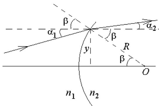
Здесь  $(\alpha_1 + \beta)$  — угол падения света на сферическую границу раздела двух сред,  $(\alpha_2 + \beta)$  — угол преломления.
