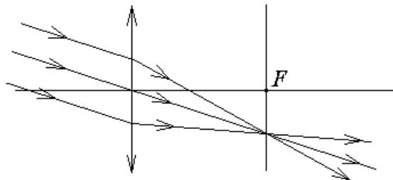
Пучок лучей параллельный оптической оси в соответствии с осевой симметрией задачи собирается в фокусе линзы.
