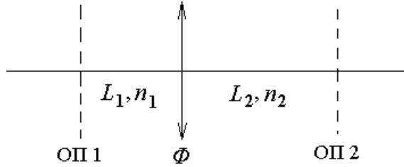
Здесь  $\Phi$  — оптическая сила линзы,  $n_1, n_2$  — показатели преломления сред с двух сторон линзы,  $L_1, L_2$  — расстояния от линзы до сопряженных опорных плоскостей.
