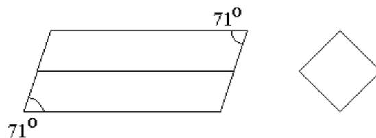
Боковые грани ромбоэдра стачивают так, чтобы превратить угол  $71^\circ$  в  $68^\circ$ . Кристалл разрезают вдоль диагональной плоскости, предварительно подобрав длину кристалла так, чтобы получить углы  $90^\circ$ :
