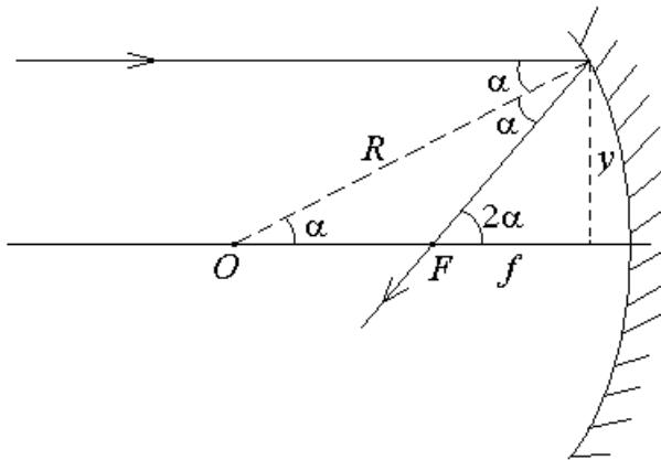
На рисунке обозначены буквой  $\alpha$  три одинаковых угла, которые примыкают к отрезку, обозначенному на рисунке буквой  $R$ . Этот отрезок — перпендикуляр к поверхности зеркала в точке касания зеркала лучом. Два верхних угла равны друг другу, как угол падения и угол отражения от зеркальной поверхности.
