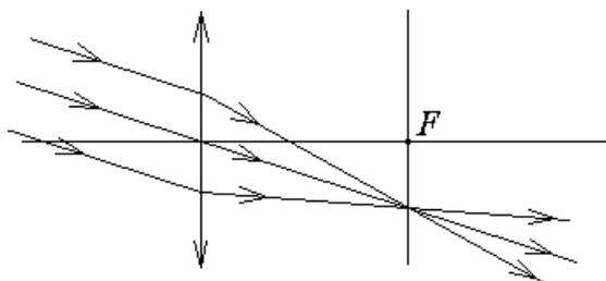
Пучок лучей параллельный оптической оси в соответствии с осевой симметрией задачи собирается в фокусе линзы.
