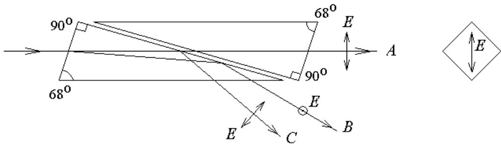
Луч  $B$ , поляризованный перпендикулярно плоскости рисунка, испытывает полное внутреннее отражение, поэтому в прошедшем горизонтально луче  $A$  нет поляризации перпендикулярной плоскости рисунка. Прошедший луч  $A$  полностью поляризован. Так из неполяризованного света на выходе призмы Николя на ее выходе получается линейно поляризованный свет.
