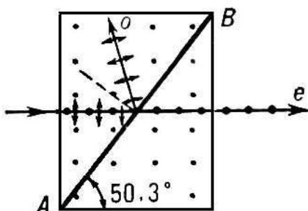
Угол  $50.3^0$  треугольной кристаллической призмы рассчитан таким образом, что полное внутреннее отражение для одной из двух линейных поляризаций света происходит при нормальном падении света на одну из граней призмы Глана-Тейлора.
