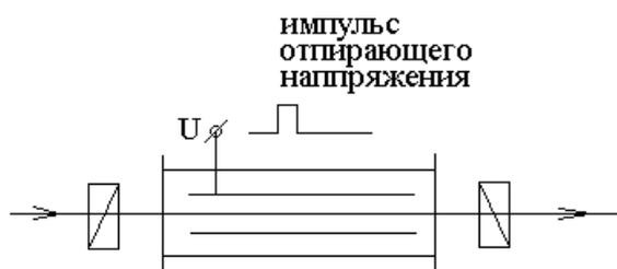
Без управляющего электрического поля жидкость изотропна, и скрещенные поляризаторы не пропускают свет.
