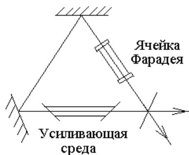
Помещение ячейки Фарадея в кольцевой резонатор приводит к тому, что оптическая длина резонатора для встречных волн различается даже без вращения резонатора. Вращение резонатора изменяет разность частот встречных волн строго линейно, что позволяет использовать кольцевой резонатор с ячейкой Фарадея в качестве лазерного гироскопа.
