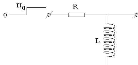
Сила тока, как функция времени после включения ступеньки напряжения на входе схемы равна
