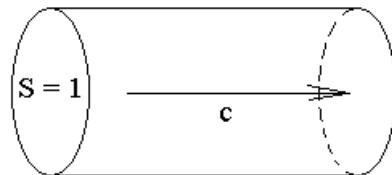
Пусть площадь сечения цилиндра равна единице, а длина —  $c$ . Тогда объем цилиндра равен их произведению  $c$ , а энергия светового поля в этом объеме равна  $wc$ . Вся эта энергия в единицу времени пройдет через единичную площадку. Следовательно,
