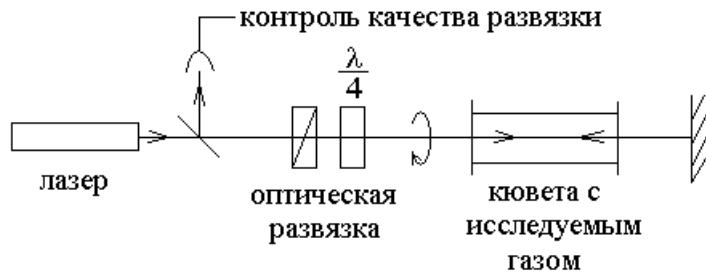
Поляризатор на оптической схеме принято обозначать, как kleеную призму, намекая на призмы Николя и Волластона.
