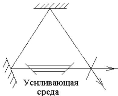
По сторонам треугольника резонатора бегут две встречные световые волны. Через полупрозрачное зеркало резонатора в правой части рисунка встречные волны выходят в разных направлениях.
