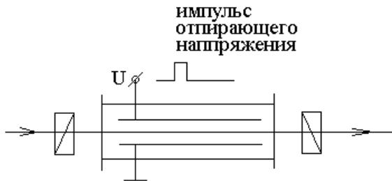
Без управляющего электрического поля жидкость изотропна, и скрещенные поляризаторы не пропускают свет.
