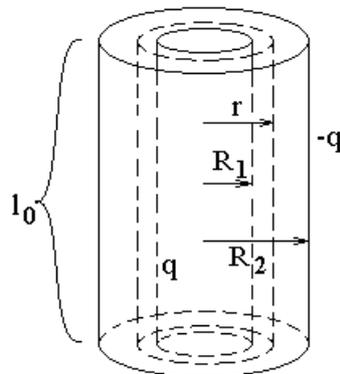
Применим теорему Гаусса для пунктирного цилиндра соосного обоим проводникам:
