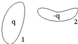
$U \equiv \varphi_1 - \varphi_2$  — определение напряжения между проводниками 1 и 2. Заметим, что напряжение и приращение потенциала отличаются друг от друга знаком.
