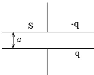
Пусть на одной пластине конденсатора находится заряд  $q$ , а на другой — заряд  $-q$ .
