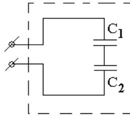
При последовательном соединении конденсаторов  $\begin{cases} U = U_1 + U_2 \\ q = q_1 = q_2 \end{cases}$ . Тогда
