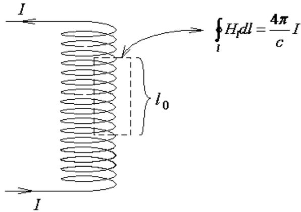
Магнитное поле снаружи длинного соленоида мало, следовательно, вклад в циркуляцию поля  $\vec{H}$  дает только вертикальный отрезок длиной  $l_0$  внутри соленоида. Тогда
