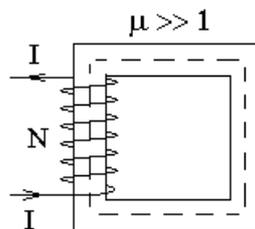
Рассмотрим циркуляцию поля  $\vec{H}$  по пунктирному контуру вдоль оси сердечника.
