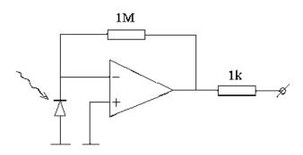
Преимущества схемы — высокая линейность, малые шумы, высокий коэффициент передачи. При указанной полярности включения фотодиода под действием света на выходе операционного усилителя образуется положительное напряжение  $U_{\rm galx} > 0$ .
