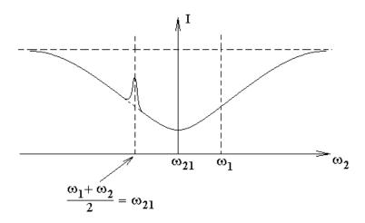
Теперь рассмотрим вариант регистрации резонанса, если частота пробной волны фиксирована  $\omega_2 = const$ . Тогда при изменении частоты насыщающей волны  $\omega_1$  интенсивность света на приемнике не изменяется до тех пор, пока не будет выполнено условие  $\frac{\omega_1 + \omega_2}{2} = \omega_{21}$ , при котором обе встречные волны поглощаются одним и тем же набором молекул:
