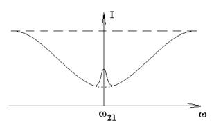
Здесь  $\omega_{21}$  — центр линии поглощения среды. Зависимость мощности света на приемнике от частоты лазера имеет широкий провал доплеровской линии поглощения, в центре которого находится узкий пик просветления среды. Пик просветления — это и есть резонанс насыщения поглощения.
