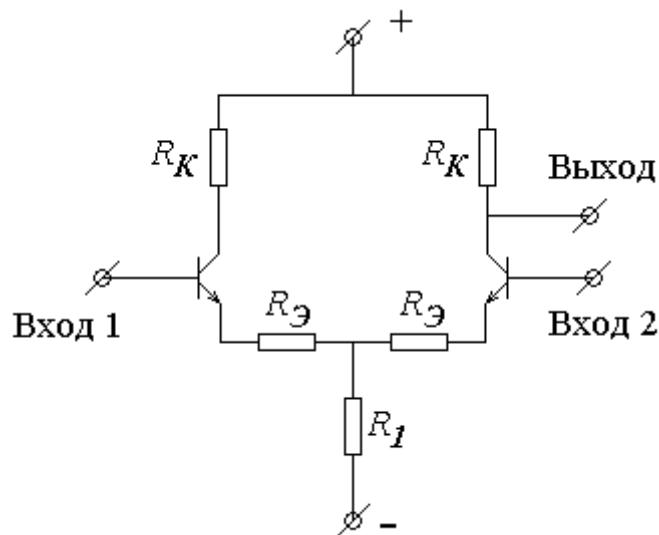
Напряжения на входах  $U_1$  и  $U_2$  можно представить, как линейную комбинацию синфазного  $\frac{U_1 + U_2}{2}$  и дифференциального  $U_1 - U_2$  сигналов. Для
