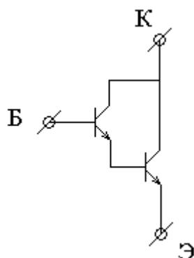
Реже используется соединение транзисторов по схеме Шиклаи, при котором также как и в составном транзисторе, схема имеет высокий коэффициент передачи по току. В этой схеме напряжение между базой и эмиттером 0.6 В.
