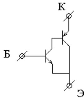
Если составной транзистор по схеме Шиклаи играет роль *n-p-n* транзистора, то более мощный в паре транзистор имеет тип *p-n-p*. Транзисторы типа *p-n-p* имеют худшие характеристики по сравнению с транзисторами типа *n-p-n*.
