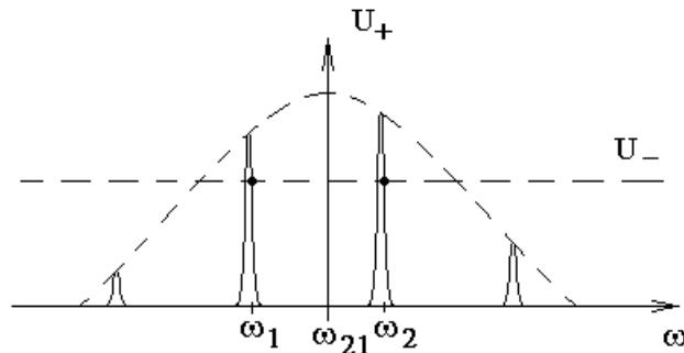
Здесь  $\omega_1$  и  $\omega_2$  — возможные стабилизированные частоты генерации, для которых сигнал ошибки равен нулю  $U_+ - U_- = 0$ , и эти положения равновесия системы стабилизации устойчивы.
