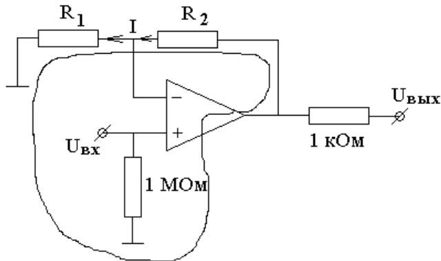
Плюс-вход ОУ соединен с общим проводом схемы через большое сопротивление  $1 \text{ МОм}$ , чтобы входные токи плюс-входа гарантированно могли достигнуть общего провода схемы.
