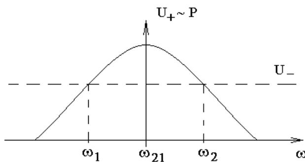
Здесь  $\omega_{21}$  — частота центра линии усиления лазерной среды, горизонтальная пунктирная линия на уровне  $U_-$  соответствует величине напряжения, которое с потенциометра подается на минус-вход дифференциального усилителя.
