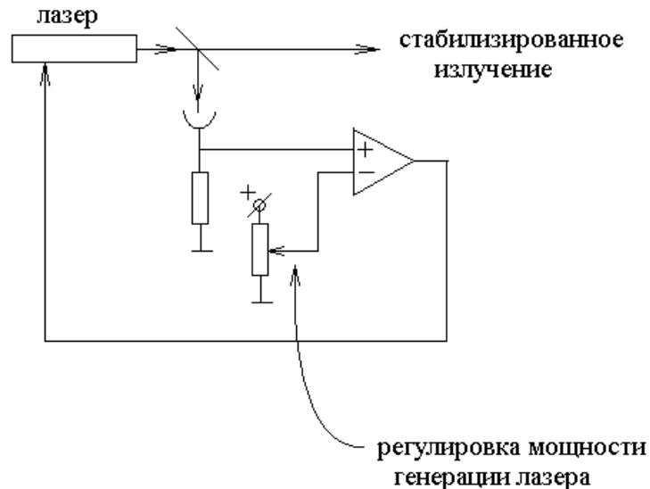
Здесь напряжение с выхода дифференциального усилителя подается на пьезокерамику, на которой укреплено одно из зеркал лазера, для управления частотой генерации лазера. Разность напряжений  $U_+ - U_-$  на двух входах дифференциального усилителя является сигналом ошибки системы стабилизации. То есть система стабилизации удерживает мощность генерации лазера на таком уровне, чтобы  $U_+ - U_- = 0$ .
