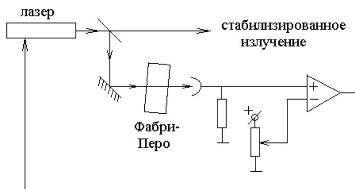
Рассмотрим на одном графике две зависимости от частоты. Зависимость мощности генерации лазера и зависимость коэффициента пропускания интерферометра Фабри — Перо.
