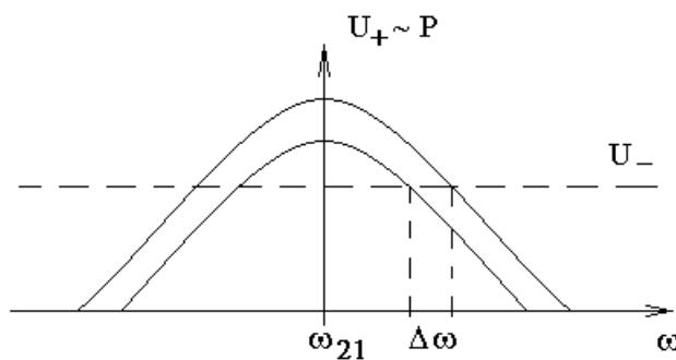
Здесь  $\Delta\omega$  — изменение стабилизированной частоты генерации лазера при изменении усиления среды.
