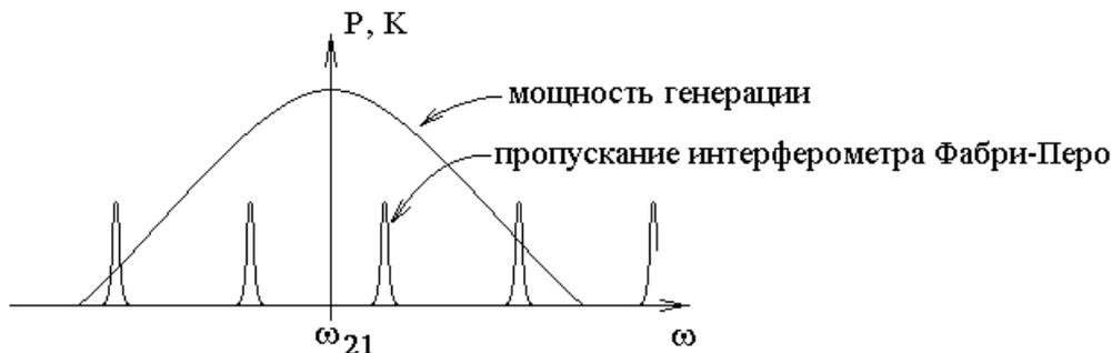
Мощность света на приемнике и пропорциональная ей величина напряжения на плюс-входе дифференциального усилителя ведут себя, как произведение представленных выше двух функций:
