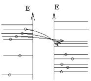
Металлы при этом заряжаются: один — положительно, другой — отрицательно. Между ними возникает двойной электрический слой (как в заряженном конденсаторе) и напряжение — контактная разность потенциалов.
