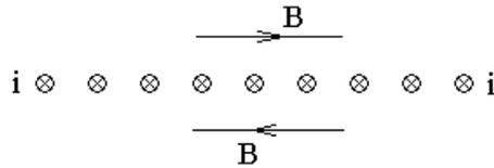
Это поле перпендикулярно току и перпендикулярно нормали к поверхности с током. Тогда магнитное поле можно найти по формуле  $dB_{\perp} = \frac{i}{c} d\Omega$ . Телесный угол, под которым видна бесконечная плоскость с током, равен  $2\pi$ . Тогда
