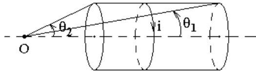
Здесь  $\theta_1$  и  $\theta_2$  — угловые радиусы доньшек цилиндра при взгляде из точки  $O$  наблюдения магнитного поля.
