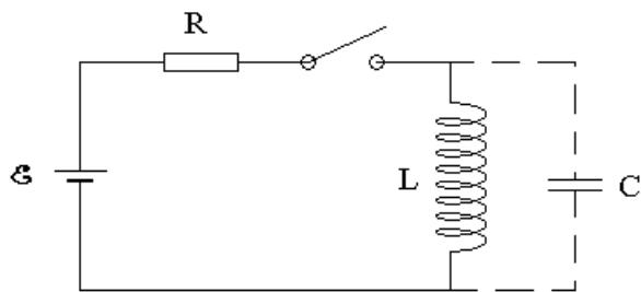
После размыкания ключа в контуре из индуктивности и емкости возникают электрические колебания. В начальный момент в катушке течет ток  $I_{\max} = I_0 = \frac{\mathcal{E}}{R}$ . Напряжение на катушке, как и на конденсаторе почти нулевое. В катушке индуктивности при этом запасена энергия магнитного поля. Ток катушки заряжает конденсатор. При максимальном напряжении на конденсаторе ток равен нулю, и вся энергия превращается в энергию электрического поля конденсатора. Тогда
