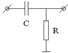
Пусть напряжение  $U_{ex}(t)$  на входе схемы — любая функция времени. Входное напряжение подается на последовательно включенные конденсатор  $C$  и резистор  $R$ , а с резистора снимается напряжение  $U_{вых}(t)$ . И пусть в любой момент времени выполнено условие  $|U_{вых}(t)| \ll |U_{ex}(t)|$ . Подразумевается, что ток на выходе схемы равен нулю, то есть к выходу ничего не подключено.
