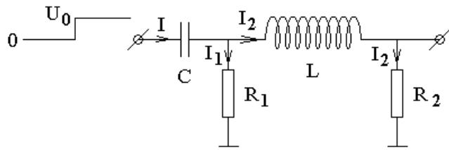
На схему в нулевой момент времени подают ступеньку напряжения с амплитудой  $U_0$ . Нужно найти напряжение на выходе схемы, как функцию времени.
