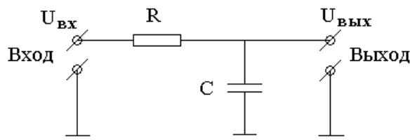
Надписи  $U_{вх}$  и  $U_{вых}$  можно не делать, так как обычно подразумевается, что напряжение подается на верхнюю клемму пары входных клемм и снимается тоже с верхней клеммы пары выходных клемм.
