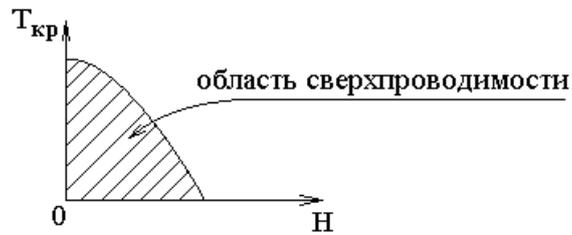
По этой причине через сверхпроводник нельзя пропустить слишком большой ток, так как большой ток создает большое магнитное поле, которое разрушает сверхпроводимость.
