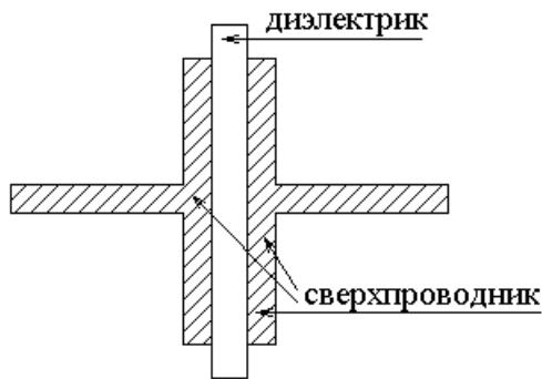
Элемент Джозефсона — плоский конденсатор из сверхпроводника. Между пластинами конденсатора помещен тонкий слой диэлектрика. Характерная толщина диэлектрика —  $1 \text{ нм} = 10^{-9} \text{ м}$ .
