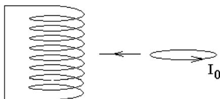
$$\begin{cases} \frac{I_0}{c}L = \frac{I}{c}L + \frac{I_c}{c}L_c \cdot \frac{1}{N} \\ 0 = \frac{I_c}{c}L_c + \frac{L_c}{N} \cdot \frac{I}{c} \end{cases} \quad \text{— это два уравнения с двумя неизвестными: } I \text{ —}$$
