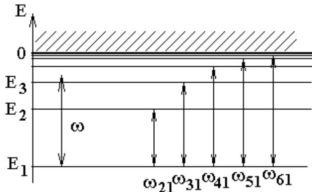
Если линия поглощения  $\omega_{n1}$  находится справа от частоты света  $\omega$ , то расстройка  $\Omega$  частоты света относительно частоты перехода отрицательная
