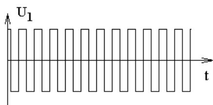
На второй вход перемножителя через конденсатор, отсекающий постоянную составляющую, поступает полезный сигнал с фотоприемника 2. Этот сигнал на частоте модуляции  $f_1$  появляется, только когда сильная световая волна  $\omega_1$  просветляет среду для слабой встречной волны  $\omega_2$ . Напряжение на втором входе перемножителя, как функция времени, имеет следующий вид:
