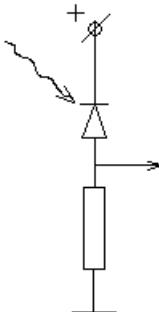
Напряжение на выходе схемы линейно возрастает с ростом интенсивности света.
