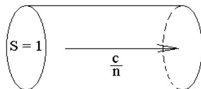
Пусть площадь сечения цилиндра равна единице, а длина —  $\frac{c}{n}$ . Тогда объем цилиндра равен их произведению  $\frac{c}{n}$ , а энергия светового поля в этом объеме равна  $w \frac{c}{n}$ . Вся эта энергия в единицу времени пройдет через единичную площадку. Следовательно,
