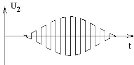
Для простоты анализа будем считать, что опорное напряжение принимает значения  $\pm 1$ . Тогда при перемножении с полезным сигналом отрицательные значения этого сигнала умножаются на  $-1$  и становятся положительными. В результате зависимость напряжения на выходе перемножителя, как функция времени, имеет следующий вид:
