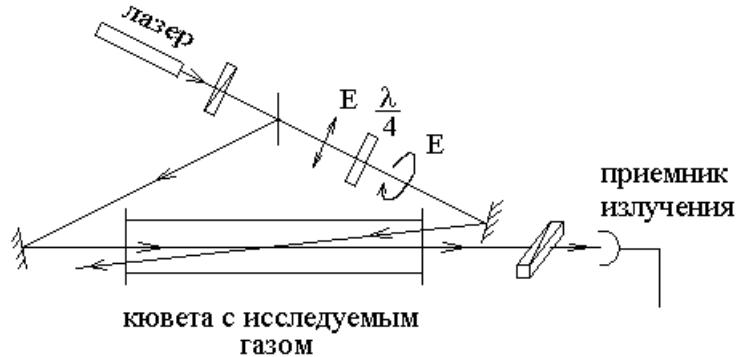
Свет лазера проходит через поляризатор. Линейно поляризованный свет отражается от полупрозрачной пластины и от зеркала и проходит кювету с исследуемым газом слева направо. Встречная световая волна, распространяющаяся справа налево, имеет круговую поляризацию, которая получается из линейной поляризации с помощью фазовой пластины  $\frac{\lambda}{4}$ .
