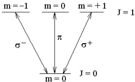
Рассмотрим схему уровней энергии в простом случае, когда квантовое число полного момента импульса  $J$  нижнего уровня энергии равно нулю, а верхнего уровня равно единице. Полный момент импульса равен  $\sqrt{J(J+1)}\hbar$  и складывается из орбитального момента импульса электронов и их спинового момента импульса.
