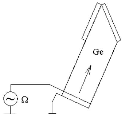
Чтобы волна была бегущей, а не стоячей, отраженную от дальнего края германия волну стараются погасить. С этой целью задний край германия срезан под углом к фронту ультразвуковой волны, и к этому краю прижата мягкая пластина, в которой ультразвуковая волна должна эффективно затухать.
