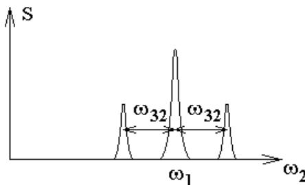
Обычно строится график зависимости сигнала  $S$  от показаний частотомера, регистрирующего модуль разности частот двух лазеров. В таком случае экспериментальная кривая будет иметь следующий вид:
