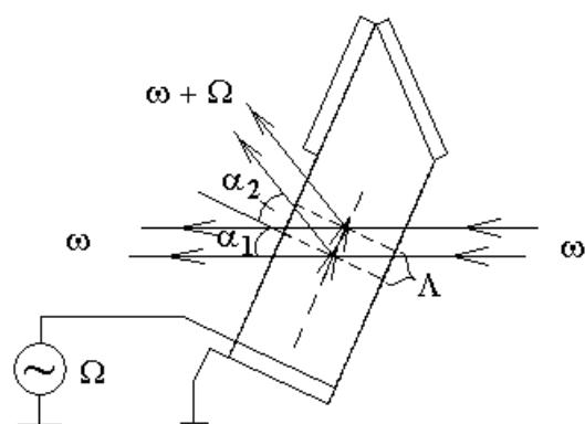
Пусть световая волна с частотой  $\omega$  падает на акустооптический модулятор справа налево. Плоскости с большим и меньшим показателем
