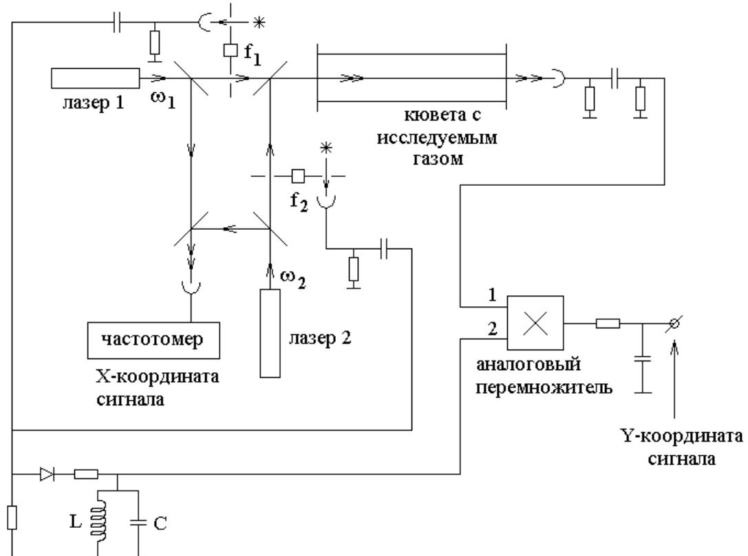
Здесь излучение лазера 1 модулируется прерывателем с частотой  $f_1$ , а излучение лазера 2 модулируется с частотой  $f_2$ . Излучение обоих лазеров направляется через кювету в один и тот же приемник света. Сигнал с приемника через конденсатор подается на вход 1 аналогового перемножителя для синхронного детектирования.
