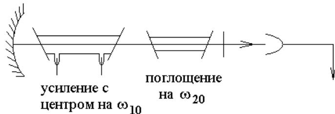
В резонаторе лазера есть две встречные волны, которые просветляют кювету друг для друга.
