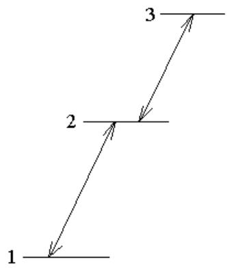
В каскадной схеме уровней энергии кроме резонансов  $\omega_1 = \omega_2$ , соответствующих каждому из переходов  $\omega_{21}$  и  $\omega_{32}$ , должны быть двойные резонансы затемнения среды.
