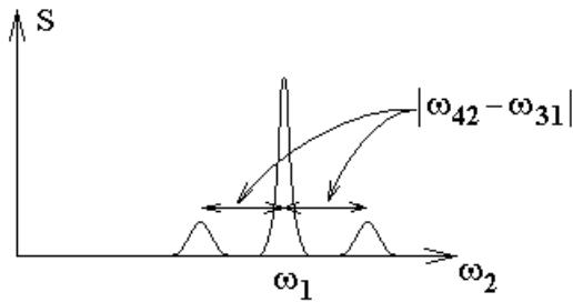
Если регистрировать сигнал  $S$ , как функцию модуля разности частот лазеров, то экспериментальная кривая будет иметь следующий вид:
