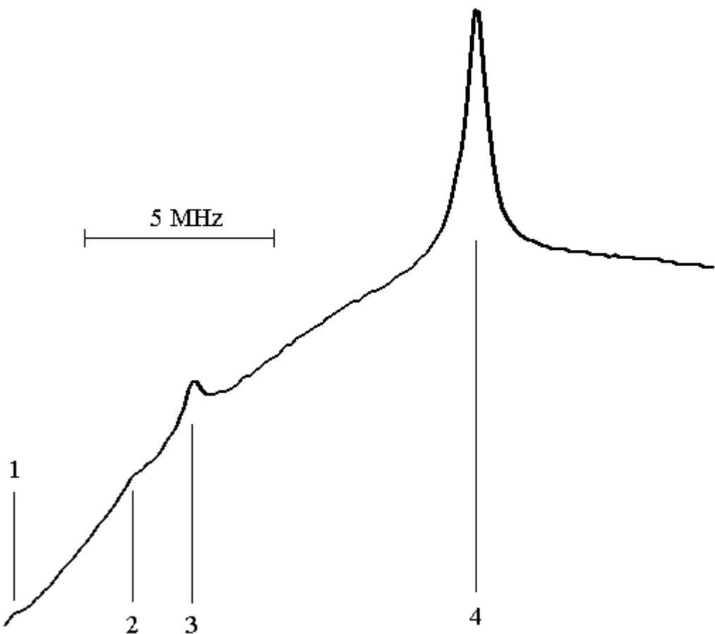
Частота генерации лазера 1 стабилизируется по резонансу 4.
