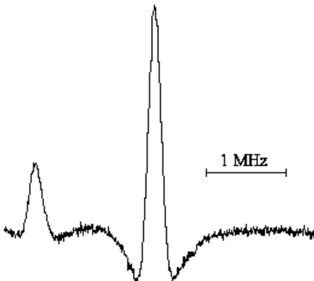
При синхронном детектировании на удвоенной частоте модуляции сигнал на выходе перемножителя 20 пропорционален второй производной зависимости мощности света на приемнике 19 от частоты генерации СО<sub>2</sub>-лазера 2. Эта же пара резонансов в зависимости мощности на приемнике 19 от частоты генерации лазера 2 видна на предыдущем рисунке, как пара резонансов 2 и 3.
