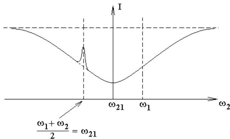
Рассмотрим традиционную схему спектроскопии насыщения поглощения, в которой излучение лазера проходит кювету с газом низкого давления, отражается зеркалом, проходит кювету с газом во встречном направлении и попадает на приемник излучения. Только рассматривается излучение импульсного лазера. Регистрируется резонансное увеличение мощности на приемнике при изменении несущей частоты лазерных импульсов.
