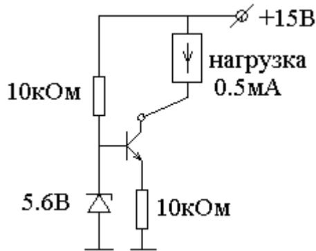
Если нужно использовать заземленную нагрузку, то источник тока придется сделать на *p-n-p* транзисторе.
