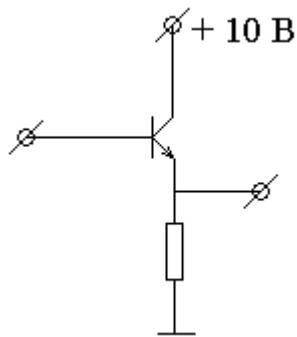
Изменение напряжения на эмиттере повторяет изменение напряжения на базе транзистора, так как напряжение на базе больше на 0.6 Вольта, на напряжение открытого диода база-эмиттер.
