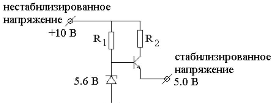
Здесь величина сопротивления  $R_1$  подбирается так, чтобы обеспечить оптимальную величину тока через стабилитрон, оптимальную для стабилизации напряжения стабилитроном (паспортная характеристика стабилитрона). Сопротивление  $R_2$  отлично от нуля чтобы защитить транзистор от перегрева в случае короткого замыкания выходного напряжения схемы.
