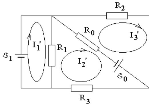
На общем для двух контуров участке цепи ток равен разности двух контурных токов.
