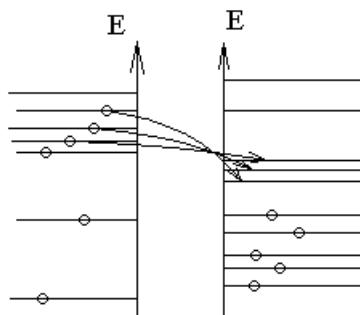
Металлы при этом заряжаются: один — положительно, другой — отрицательно. Между ними возникает двойной электрический слой (как в заряженном конденсаторе) и напряжение — контактная разность потенциалов.
