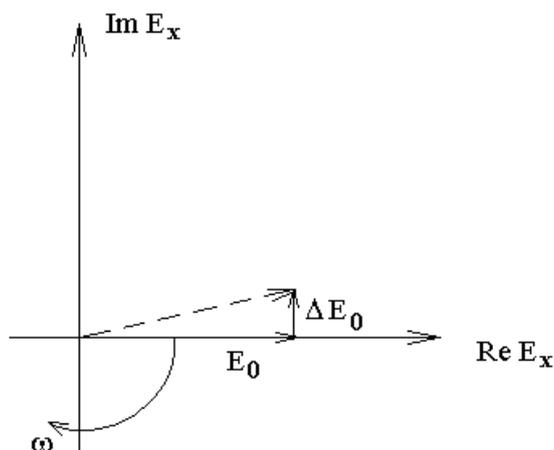
Здесь  $\vec{E}_0$  — комплексная амплитуда падающей световой волны,  $\vec{\tilde{E}}_0$  — амплитуда излучения слоя диполей. Пунктирный вектор — это комплексная амплитуда света после прохождения тонкого слоя среды. Комплексная амплитуда повернулась против вращения во времени комплексной напряженности светового поля. Это означает отставание по фазе световой волны после прохождения тонкого слоя среды от световой волны, которая распространялась бы в вакууме.
