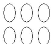
Так если форма лазерного пятна представляет собой две строки по три светлых пятна, то индексы соответствующей поперечной моды 2,1 — две темные полосы при перемещении по  $x$  координате и одна темная полоса при перемещении по  $y$  координате.
