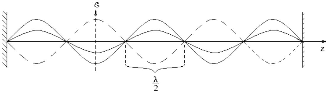
В резонаторе работающего лазера присутствует стоячая волна. На зеркалах лазера находятся узлы стоячей волны. Следовательно, на длине резонатора  $L$  укладывается целое число полуволн  $L = m \frac{\lambda}{2}$ , где  $m = 1, 2, 3, \dots$  — целое число. Лазер может излучать только такой свет, длина волны  $\lambda$  которого удовлетворяет равенству  $L = m \frac{\lambda}{2}$ .
