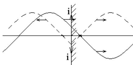
По поверхности зеркала течет переменный ток  $i$  с оптической частотой. Этот ток излучает плоскую электромагнитную волну одинаково направо и налево в обе стороны от поверхности зеркала. Волна, излученная направо в глубину зеркала (изображена пунктиром), интерферирует с прошедшей сквозь зеркало падающей волной (сплошная линия) и полностью ее гасит. Следовательно, плоскость токов излучает направо волну со сдвигом фазы  $\pi$  по отношению к проходящей сквозь зеркало волне.
