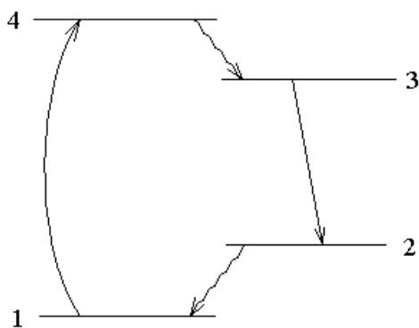
В плазме газового разряда свободные электроны ускоряются электрическим полем, ударяются о нейтральные атомы газа и, передавая часть энергии атому, переводят его из состояния с уровнем энергии 1 в состояние с уровнем энергии 4. Это так называемая накачка уровня 4 разрядом в газе.
