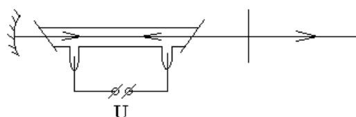
Мы для простоты рассмотрим резонатор лазера с двумя плоскими зеркалами.
