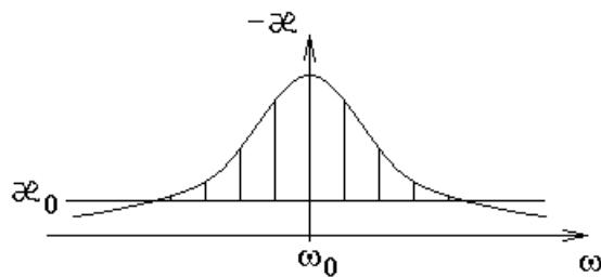
если ширина спектральной линии усиления определяется эффектом Доплера. Здесь длины вертикальных отрезков пропорциональны величине мощности излучения лазера на соответствующих частотах.
