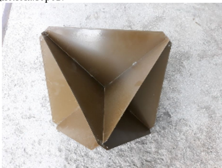
Металлический уголкового отражатель для радиоволн.
