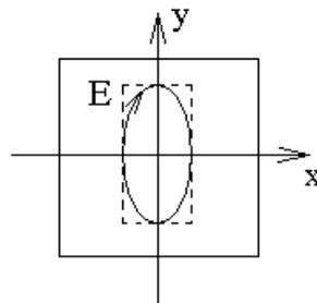
Если на пластинку  $\frac{\lambda}{4}$  падает свет, линейно поляризованный вдоль оси  $y$ , то на выходе из пластинки он останется линейно поляризованным вдоль  $y$ . Аналогично для света, поляризованного вдоль оси  $x$ .
