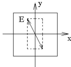
Повернем пластинку  $\frac{\lambda}{2}$  так, чтобы поляризация падающей волны была направлена вдоль оси  $y$ . Затем повернем пластинку вместе с осью  $y$  на некоторый угол вокруг луча. Как видно из двух последних рисунков, поляризация света на выходе поворачивается на удвоенный угол.
