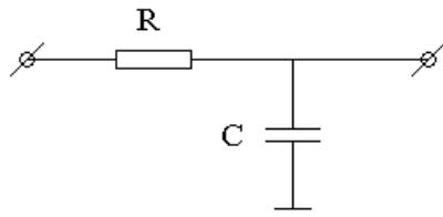
Пусть напряжение на входе схемы  $U_{\text{вх}}(t)$  — любая функция времени и пусть в любой момент времени выполняется условие  $|U_{\text{вых}}(t)| \ll |U_{\text{вх}}(t)|$ .
