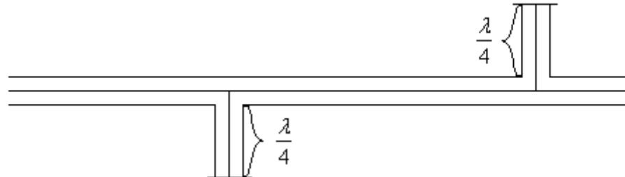
Конец четвертьволнового стакана является коротким замыканием, а сам стакан воспринимается сигналом центральной жилы, как разрыв, а не как короткое замыкание. По ходу распространения сигнала таких стаканов может быть несколько. В настоящее время четвертьволновым стаканом называют несколько иную конструкцию, а то, что рассмотрели мы, называют четвертьволновым штырем.
