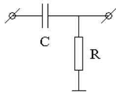
Пусть напряжение  $U_{\text{вх}}(t)$  на входе схемы — любая функция времени. Входное напряжение подается на последовательно включенные конденсатор  $C$
