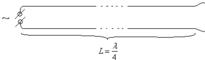
Пусть длина двухпроводной линии  $L = \frac{\lambda}{4} = 1500 \text{ км.}$  В таком случае оказывается, что короткое замыкание на удаленном конце линии будет восприниматься источником напряжения, как разрыв, а не как короткое замыкание.
