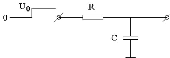
Пусть резистор и конденсатор включены последовательно. На эту схему в нулевой момент времени подают ступеньку напряжения величиной  $U_0$ . Нужно найти напряжение на конденсаторе, как функцию времени.
