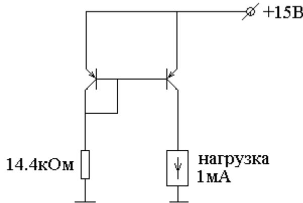
Согласованные транзисторы или согласованная пара транзисторов — это транзисторы с максимально одинаковыми характеристиками. Токовое зеркало часто используются внутри схемы операционного усилителя. Операционные усилители будут рассмотрены позднее.
