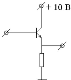
Изменение напряжения на эмиттере повторяет изменение напряжения на базе транзистора, так как напряжение на базе больше на 0.6 Вольта, на напряжение открытого диода база-эмиттер.
