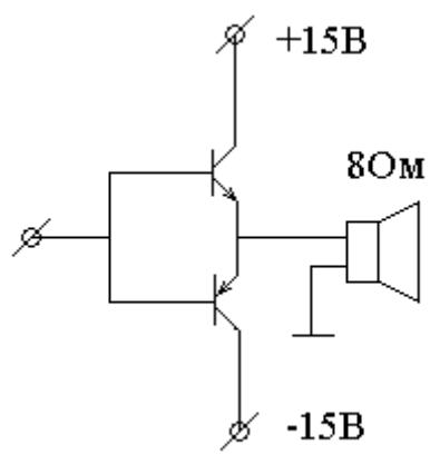
В данной схеме при нулевом сигнале на входе мощность не рассеивается вовсе. Однако малые сигналы с амплитудой меньше 0.6 В в этой схеме не проходят на выход, а большие сигналы испытывают нелинейные переходные искажения, когда сигнал переходит через нуль. В результате искажается звук.
