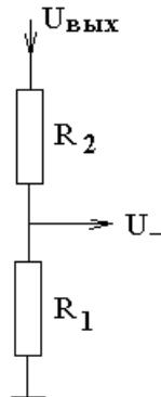
С выхода на минус-вход поступает часть напряжения  $\beta = \frac{R_1}{R_1 + R_2}$ . Тогда
