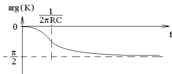
Здесь  $|\arg(\tilde{K})|$  — это запаздывание по фазе напряжения на выходе схемы относительно напряжения на входе. Запаздывание, так как  $\arg(\tilde{K}) < 0$ .
