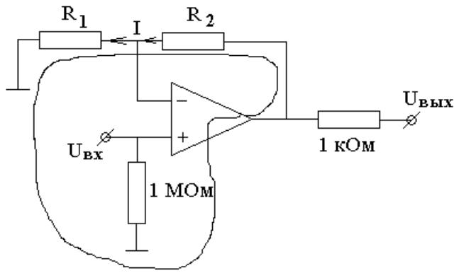
Плюс-вход ОУ соединен с общим проводом схемы через большое сопротивление 1 МОм, чтобы входные токи плюс-входа гарантированно могли достигнуть общего провода схемы.
