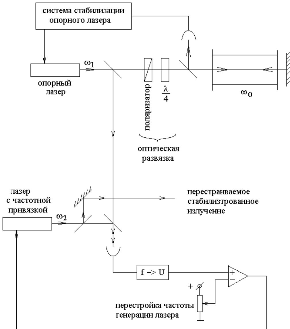
Здесь верхний так называемый опорный лазер стабилизирован по резонансу насыщения поглощения. Вся электронная часть системы стабилизации опорного лазера изображена одним прямоугольником.
