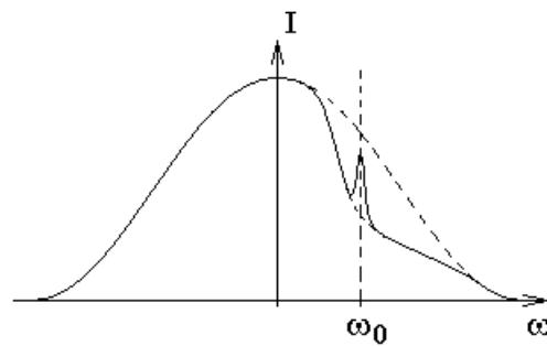
Здесь  $\omega_0$  — центр линии поглощения газа в кювете, пунктирная часть зависимости — мощность генерации лазера. Вокруг частоты  $\omega_0$  в мощности света на приемнике появляется широкий доплеровский провал линии поглощения газа, находящегося в кювете. В центре линии поглощения на частоте  $\omega_0$  наблюдается узкий пик резонанса насыщения поглощения.
