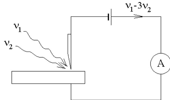
Это приемник, который реагирует на напряженность электрического поля световой волны, а не на интенсивность, как остальные приемники оптического диапазона. Например, в фототоке приемника можно получить сигнал на частоте  $v_1 - 3v_2$ , если эта частота достаточно низкая.
