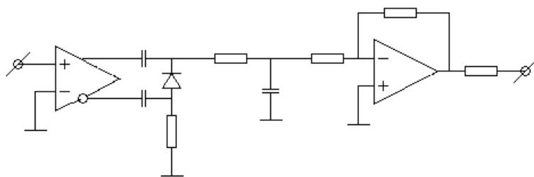
Слева — компаратор с двумя выходами, справа — операционный усилитель.
