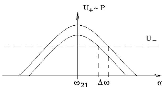
Здесь  $\Delta\omega$  — изменение стабилизированной частоты генерации лазера при изменении усиления среды.
