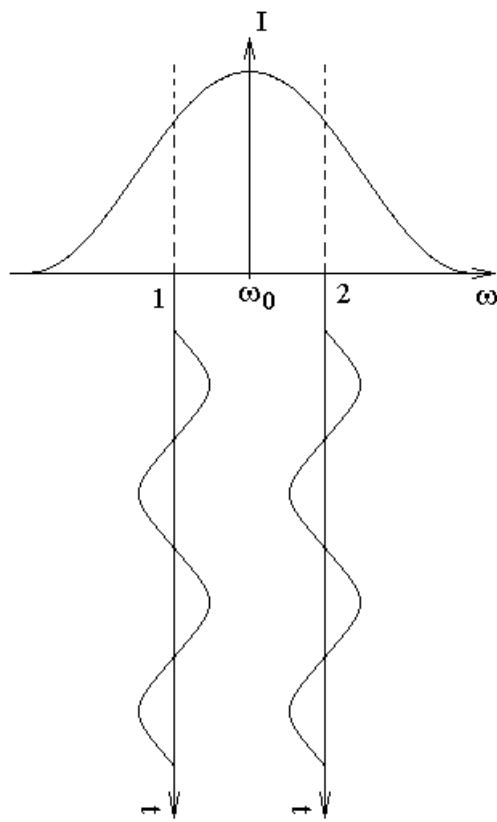
Из рисунка видно следующее. Если средняя частота генерации находится на левом склоне резонанса и качнулась чуть вправо, то мощность на приемнике возросла. Если же средняя частота находится на правом склоне и качнулась чуть вправо, то мощность уменьшилась. То есть на двух склонах резонанса фаза колебаний напряжения с приемника будет противоположной.
