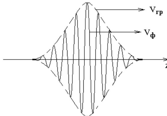
Групповая скорость  $V_{гр}$  — это скорость движения огибающей светового импульса.
