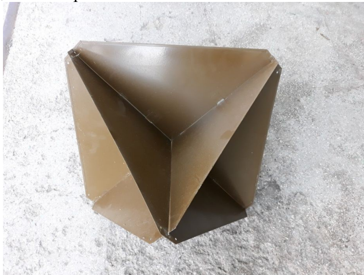
Металлический уголкового отражатель для радиоволн.
