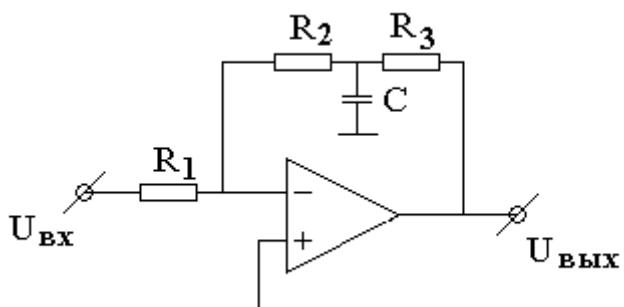
Пусть  $R_2 \gg R_3$ , тогда подъем начинается с частоты  $\omega = \frac{1}{R_3 C}$ .
