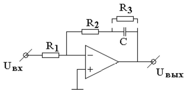
Подъем начинается с частоты  $\omega = \frac{1}{R_2 C}$  и происходит на более низких частотах. Параллельно конденсатору можно подсоединить большое сопротивление  $R_3$  для прекращения подъема на очень низких частотах
