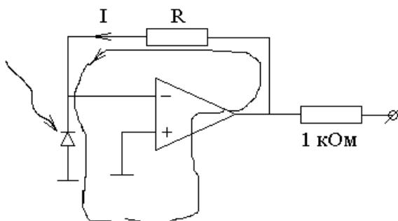
Под действием света в фотодиоде возникает фототок пропорциональный мощности света. Этот ток не может протекать через "—" вход операционного усилителя. Следовательно, весь фототок протекает через резистор обратной связи сопротивлением  $R$ . Типовое значение сопротивления  $R = 1 M\Omega$ .
